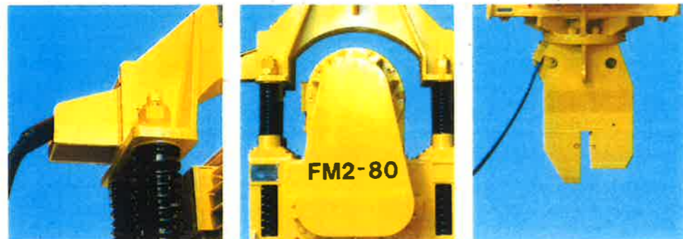
1. キャブタイヤ取り出し部 2. プーリーカバー部 3. チャック部
