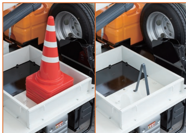
≫セーフティーコーン収納 03 最大10個まで搭載可能。
